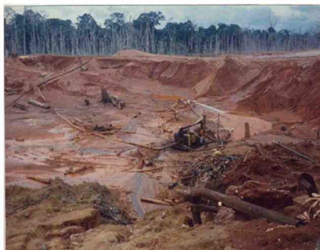
Figura 6 - Desmonte hidráulico em aluvião Aatoria EBESA, 1991
