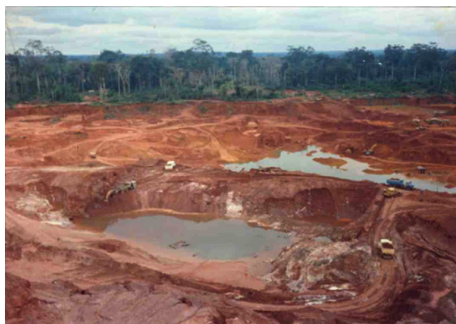
Figura 4 - Desmonte Mecânico e Hidráulico em Granito Rapakavi –Serra Bom Futuro – Autoria - EBESA, 1991
