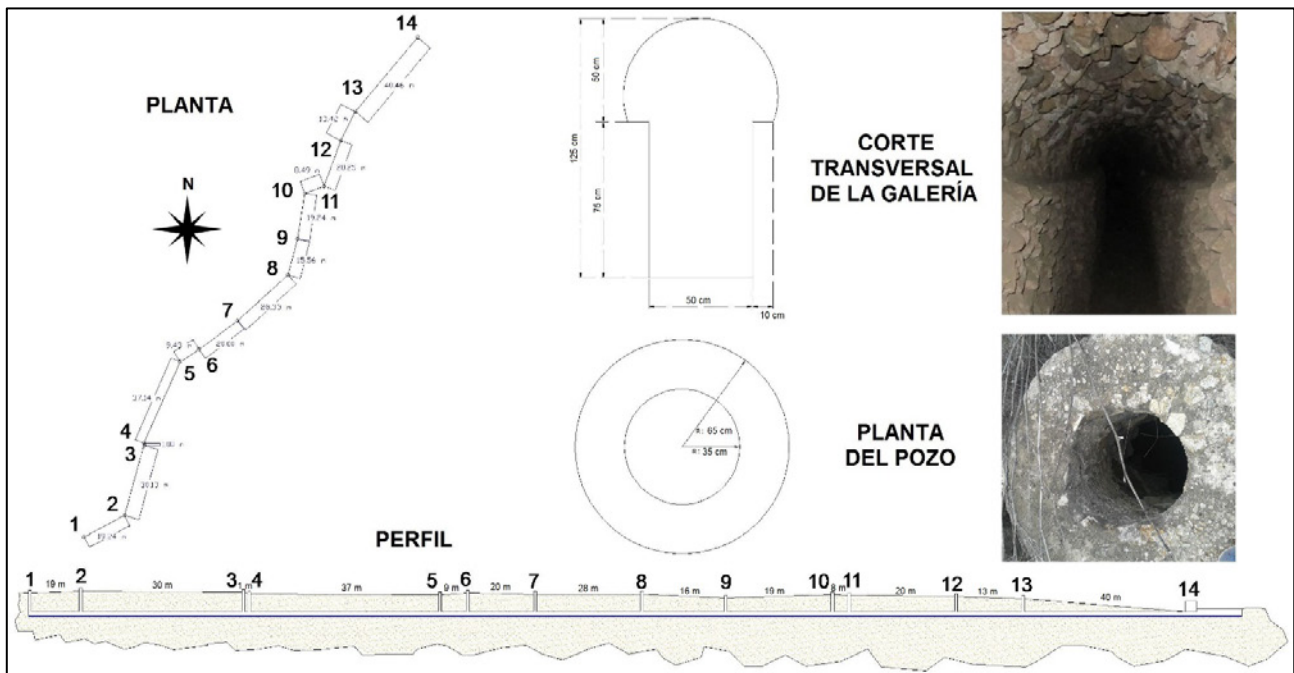
Figura 2. Medidas de la galería subterránea con lumbreras (plantas, perfil y corte transversal).
